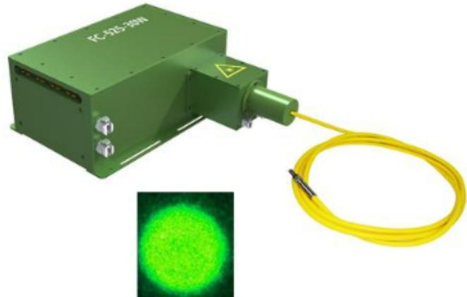
高功率绿光激光器在铜材焊接上的应用：有色金属铜的黄金搭档，在室温下，铜对绿光波长的吸收率高达40%，是对传统近红外光吸收率的8倍以上，因此，具有绿光波长的高功率连续激光器可以焊接高反材料铜且几乎无飞溅，这满足了我们对于铜焊接的质量较高的要求。优异的光束质量：通快的碟片设计，可保证激光器实时功率闭环反馈，功率输出稳定在±1%，保证激光加工过程的工艺稳定性，绿光波长高功率连续激光器可在兼具高功率输出的基础上，确保出色的光束质量，相较于蓝光半导体，通快绿光能达到。杭州一全光电的绿光激光器结构紧凑，容易安装。
